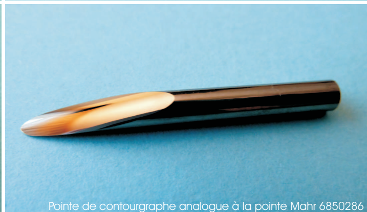
Palpeur de contourgraphe pour machine Mahr LD120
